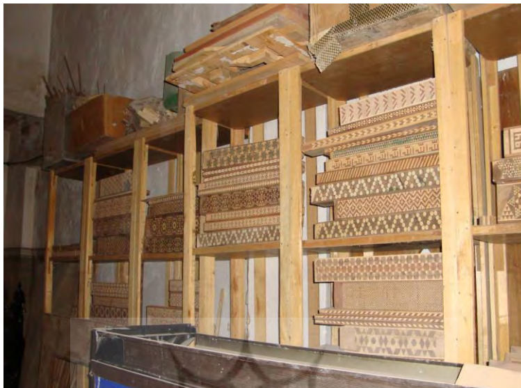
تصویر ۹- آماده کردن قامه‌های جوک با طرح‌های مختلف، قبل از برش و چسباندن، کارگاه نجاری استاد کاظم جوریزی، شیراز
