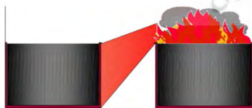
شکل ۲. مکانیزم تابش گرمایی در اثرات زنجیره‌ای (Ghasemi & Nourai, 2017)
