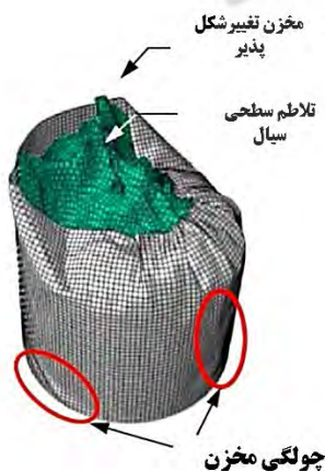
شکل ۴. امواج سطحی سیال در مخازن در اثر بار انفجار (Mittal et.al, 2014)
